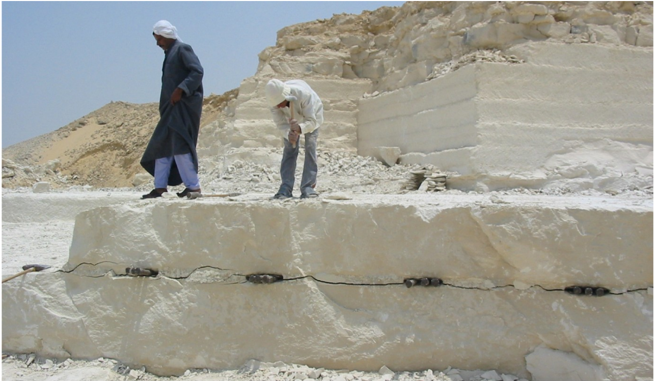
Carrière d'extraction manuelle existant encore aujourd'hui dans la couche Observatory à HELWAN
