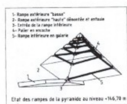
Etat des rampes de la pyramide au niveau +146,79 m
