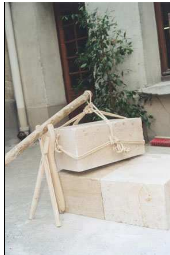
Modélisation de la manœuvre à l'échelle 1/3 (soit 1/27), les blocs pèsent 100 kg
