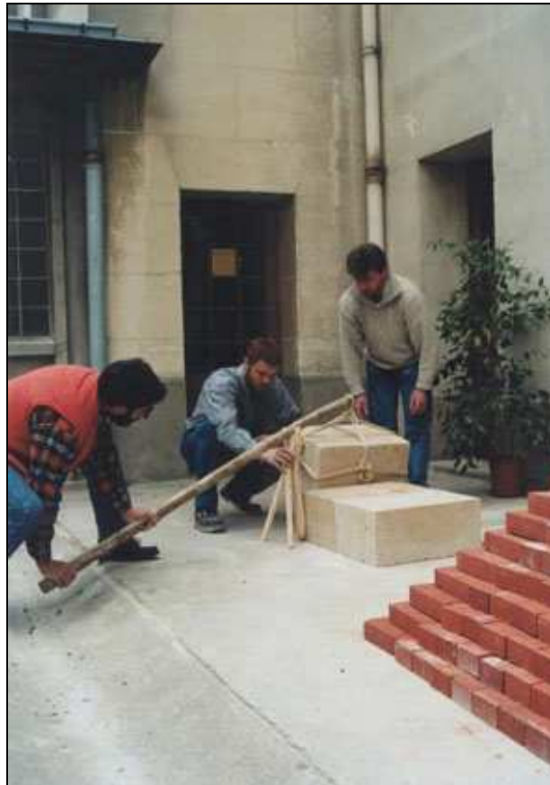
Modélisation de la manœuvre à l'échelle 1/3 (soit 1/27), les blocs pèsent 100 kg
