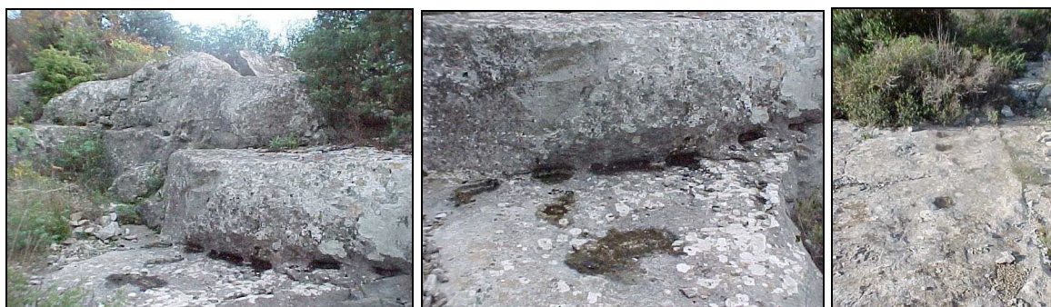
Figure 9. Carrières romaines, les encoches d'extraction entre les strates laissent des empreintes (ici remplies d'eau), on aperçoit aussi la fracturation sur le carreau.
