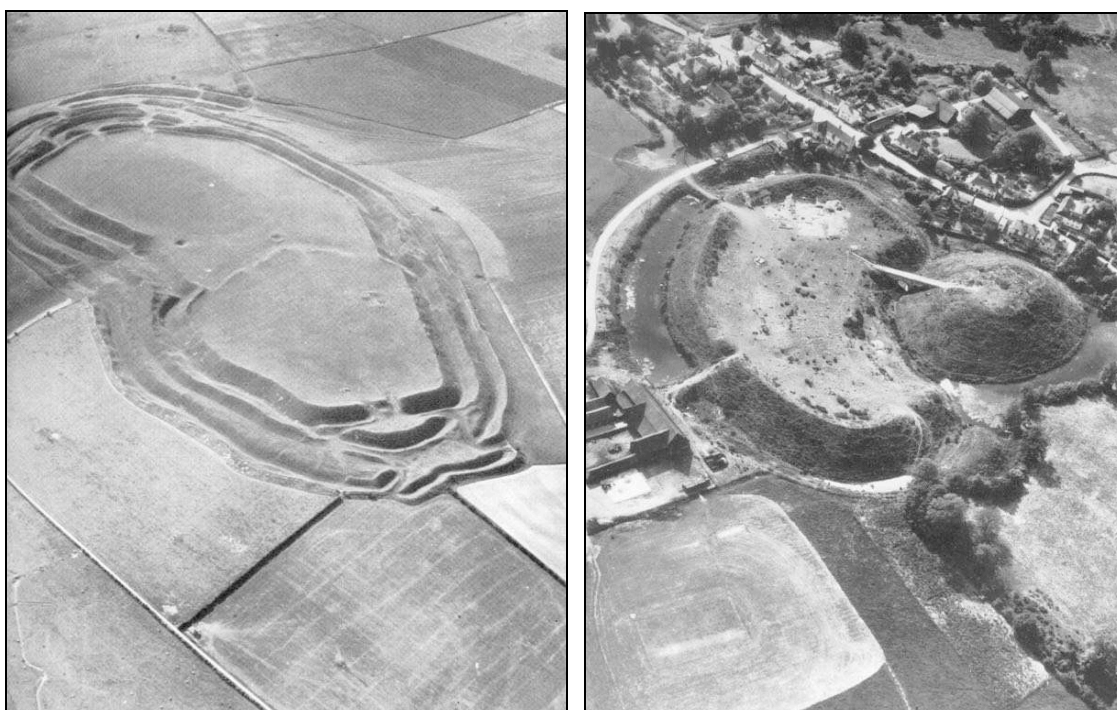
Figure 3. Exemples d'équilibre des masses en Génie Militaire : triple ceinture de « fossés et talus » de Maiden Castle dans le Dorsetshire et Ouvrage en « Motte et lice », à Pleshey dans l'Essex (Angleterre)
