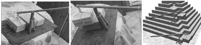
**Figure 6.** Modélisation du mouvement élémentaire au 1/10 (© P. Crozat) et simulation informatique, à droite, montrant une position possible pour les trépieds
